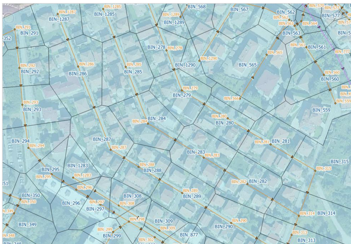
Figura 49 - Esempio estratto planimetrico definizione sottobacini (blu) afferenti ai nodi della rete (arancione) per il calcolo dell'area drenata dagli sfioratori.
